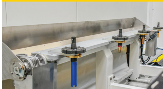
FOUR POSITION MAGNETIC TOOL CHANGER FOR AUTO CHANGING CORE BITS AND ROUTER TOOLS CAMBIO MAGNETICO A QUATTRO POSIZIONI PER FORATURA E FRESATURA IN AUTOMATICO
