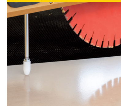
SLAB THICKNESS READER LETTORE SPESSORE LASTRA
