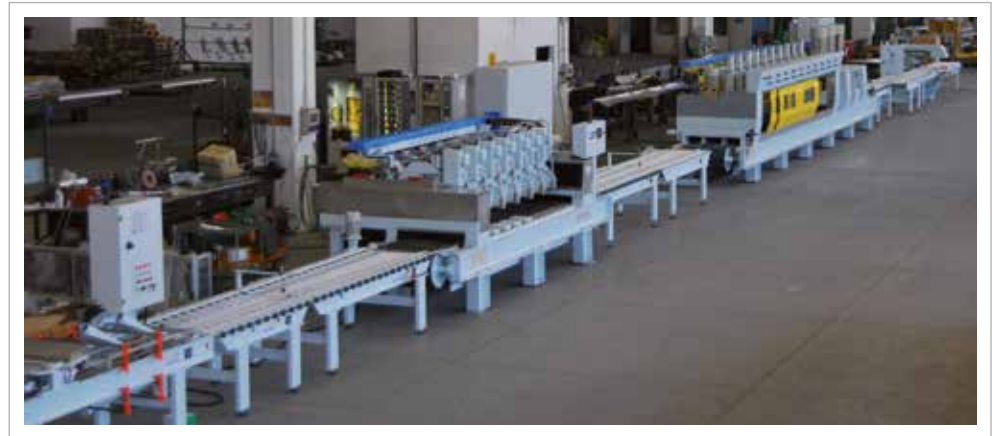
Polishing, cutting and chamfering line with LMS C3 + 12A Linea di lucidatura, taglio e bisellatura LMS C3 + 12A
