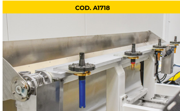
FOUR POSITION MAGNETIC TOOL CHANGER FOR AUTO CHANGING CORE BITS AND ROUTER TOOLS CAMBIO MAGNETICO A QUATTRO POSIZIONI PER FORATURA E FRESATURA IN AUTOMATICO
