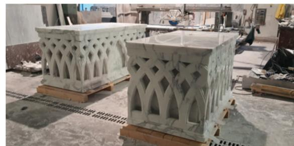
plice e produrre oggetti complessi (tridimensionali) utilizzando utensili diamantati cilindrici per la sgrossatura e conici per la finitura dei dettagli.
