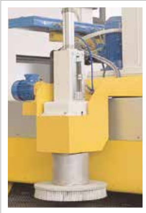
Slabs cleaning unit Gruppo di pulitura lastre
