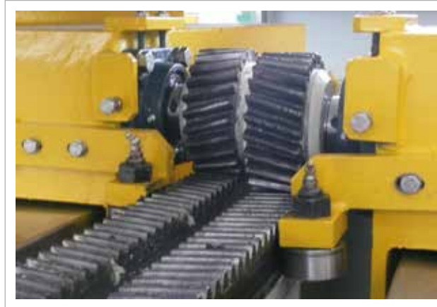
Beam movement in oil bath and hermetic protective seals Scorrimento della trave in bagno d'olio e protezioni ermetiche
