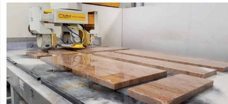
**La Linea GL3 CN2** completamente automatica è composta da un caricatore automatico per grossi masselli che alimenta il banco/nastro per la zona taglio, dove il materiale viene processato e successivamente trasportato al banco/nastro zona scarico pronto per la palettizzazione.
